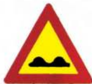
(Κ - 9) Επικίνδυνο ανώμαλο οδόστρωμα, σε κακή κατάσταση, με λάκκους κ.λ.π.
