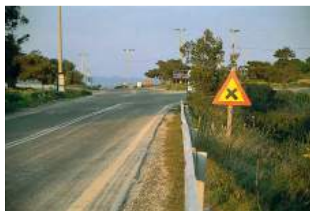
Σχ. 3.8 Προσέγγιση σε διασταύρωση στην οποία η σήμανση (πινακίδα) υποδεικνύει ότι ισχύει ο κανόνας της εκ δεξιών προτεραιότητας.
