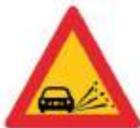
(K-13) Επικίνδυνη εκτίναξη χαλίκων (ασύνδετο αμμοχάλικο).
