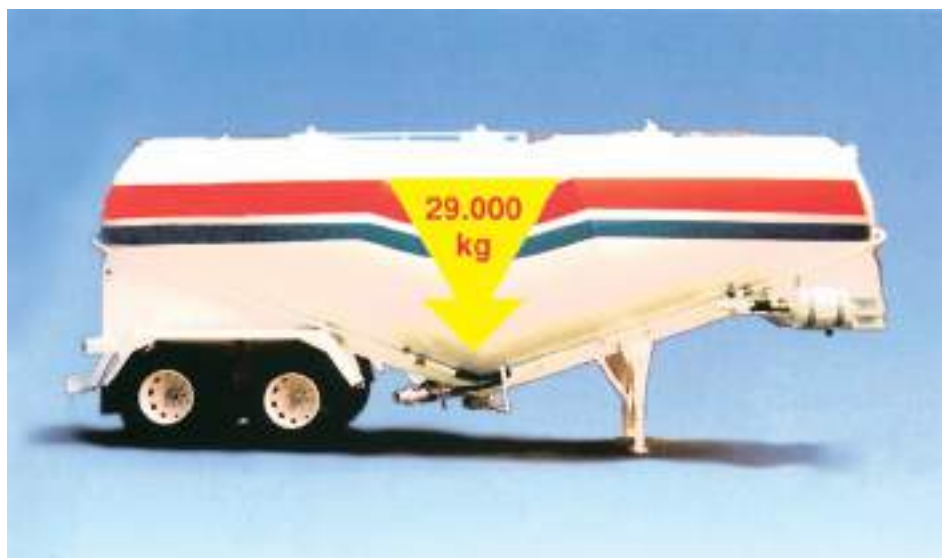
Σχ. 1.18 Μέγιστο επιτρεπόμενο βάρος διαξονικού ημιρυμουλκούμενου.
