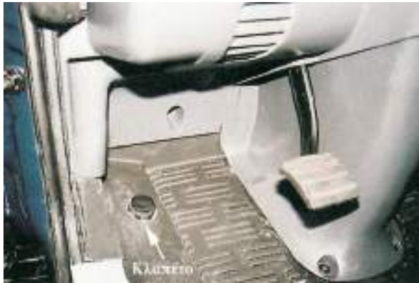
Σχ. 9.34 Μηχανόφρενο κλαπέτο.
