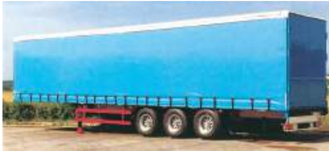
(α) Επικαθήμενο με μεταλλικές αφίδες και σταθερό μουςαμά.
