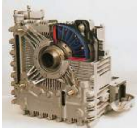
Σχ. 9.36 Υδραυλικός επιβραδυντής.
