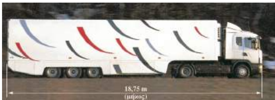
Σχ. 1.8γ Μέγιστο μήκος αρθρωτού οχήματος.
