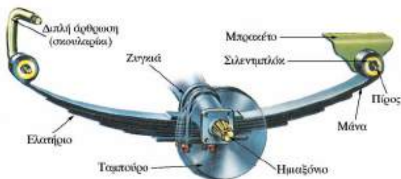
Σχ. 9.28 Χαρακτηριστικά μηχανικής αναρτήσεως.
