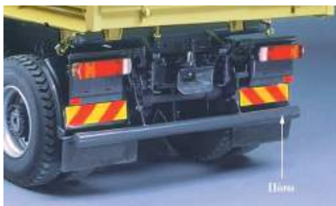
Σχ. 2.14 Προστατευτική διάταξη στο πίσω μέρος.
